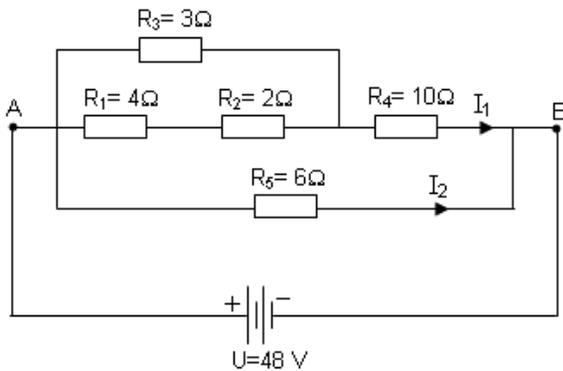
Determine a resistência equivalente e as correntes  $I_1$  e  $I_2$  indicadas no circuito e a diferença de potencial sobre o resistor  $R_4$ .
